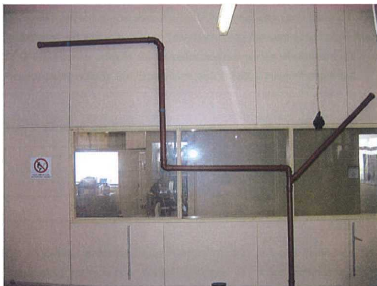
Фиг. 1: Тестова установка за херметичност при отрицателно налягане
