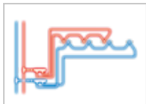
Сериен монтаж, като се използват тройни адаптори
