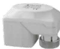
WH-EMU230 230V, IP 40 Дължина на хода: 8 mm Сила на отваряне: 180 N Общо време на отваряне: 210 s (0,038 mm/s) Кабел: 2 m., 3 x 0,5 mm 2 Съединителен пръстен: M30 x 1,5
