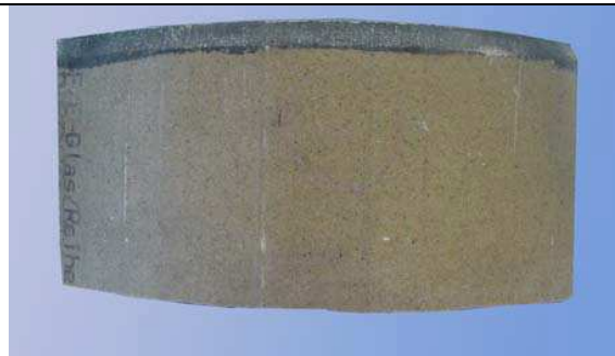
Снимка 206: стойка 2,27, връзка 4 (външна повърхност на тръбата след приключване на теста)
