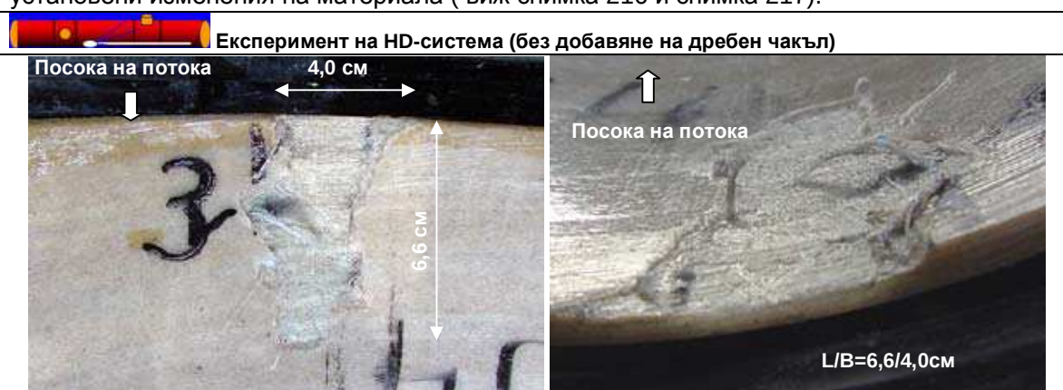
Снимка 215: Натоварване: 50 цикъла- без дребен чакъл- дюза D1 (8x30°), вдясно уголемено изображение
