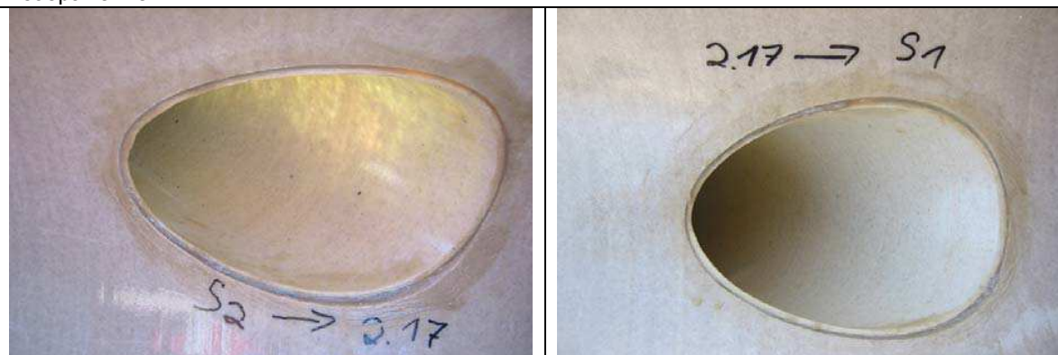
Снимка 216: Натоварване: 50 цикъла- без дребен чакъл –D1 (8x30°),
