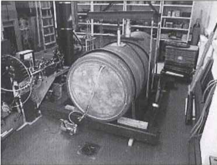
Gasdichtheit bei innerem Unterdruck nach Verformung
