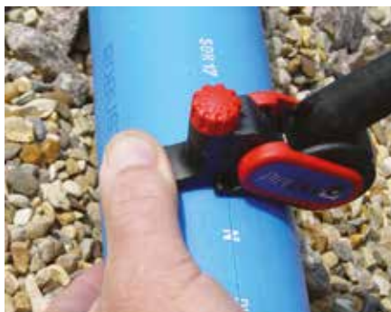
Извършвайте въртеливи движения с инструмента като придържате здраво с палеца и отстранявайте външния слой на тръбата.
