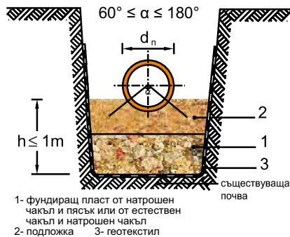
Фиг. 6.3 Пример за полагане в слаба почва (лъс) с дълбочина \leq 1,0 m
