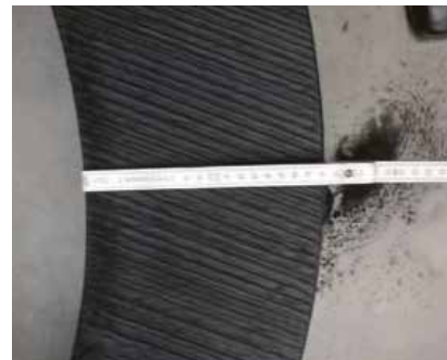
Плътностенна тръба от полиетилен s = 180 \text{ mm}
